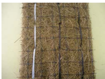
写真1 侵食コントロールブランケットC125
