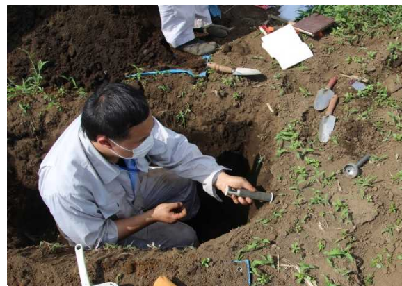
図2 土の締まりの調査の様子
