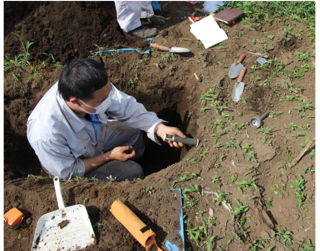
土の締まりを測定している様子
