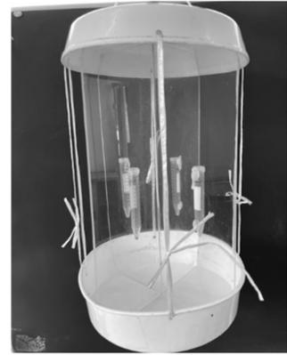
図2 作成した衝突板トラップ
