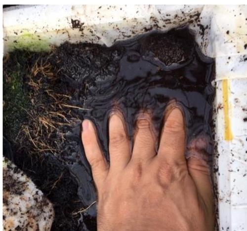
図 11 水が抜けなくなった培地槽
