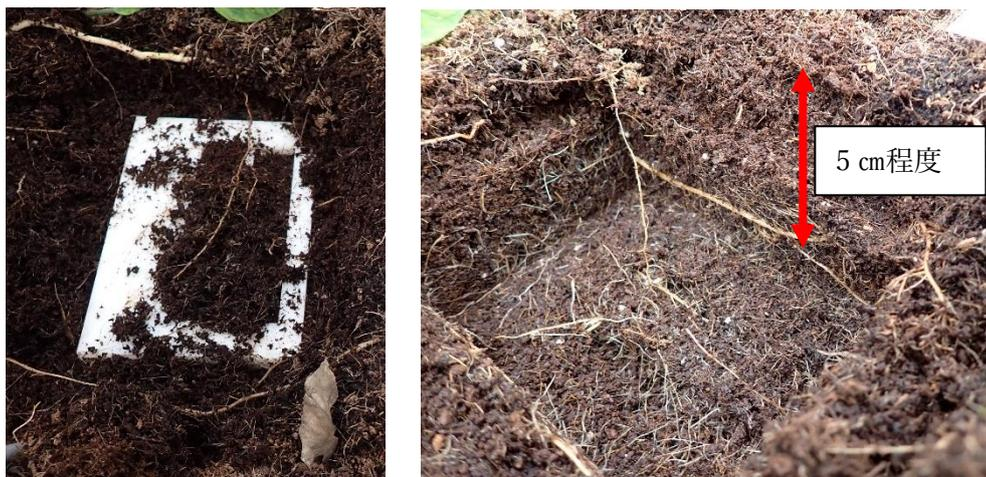
図7 左：水分センサの設置状態(表面のヤシガラを除去し埋設したところ)、
