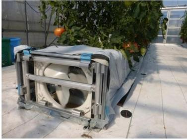
図1 培地気化冷却システム
