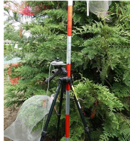
図2 光量子束密度の測定状況 センサーは、GA 処理枝の平均的な高さである地上 125cm の高さ、幹から概ね 120cm 離れた位置に設置した。
