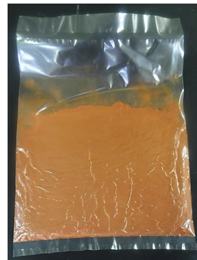
図6 脱気シール処理(例)
