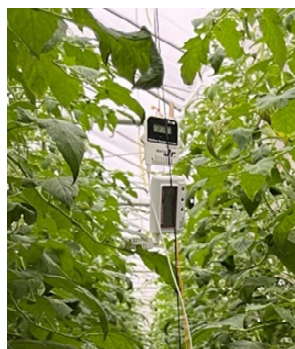
子機はベッド間で植栽を挟んだ状態で設置
