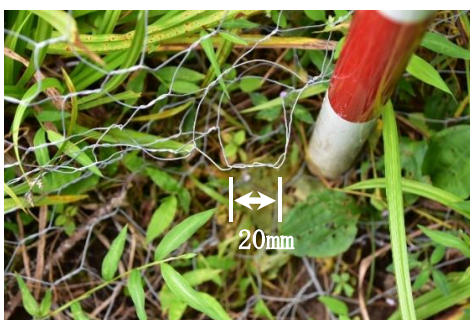
図 2 亀甲金網のタヌキによると推定される痕跡(上から下方を望む)
