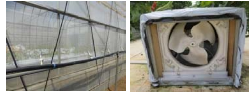
図1 試験で使用した気化冷却システム
