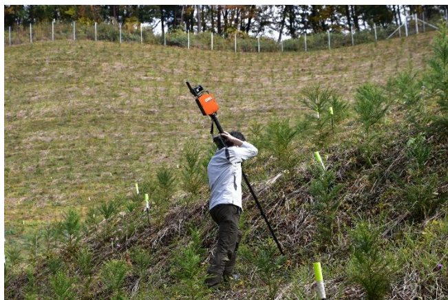
図3 地上型レーザスキャン （苗木計測用に特殊な杭を使用）
