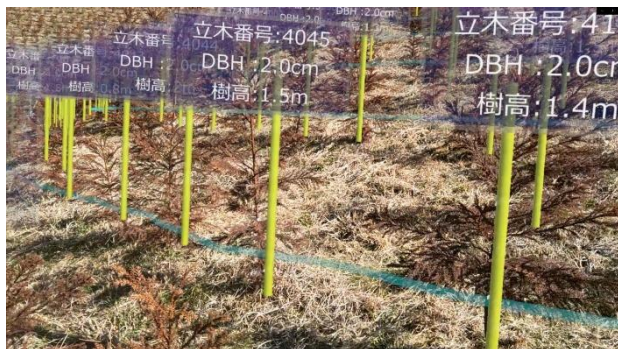
地上型レーザによる樹高解析
