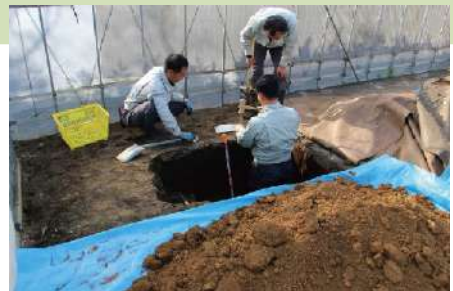
試坑による土壌の特性調査
