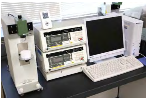
うどんの食感（硬さ）を 測定する物性測定器
