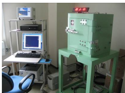
図14 ゲルマニウム半導体検出器による放射性物質の調査分析
