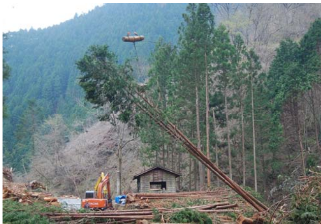
図 11 架線による集材作業
