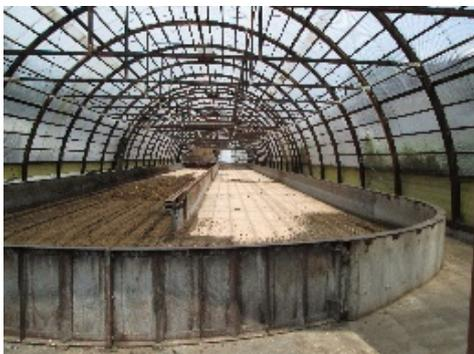
横型ロータリー式発酵槽
