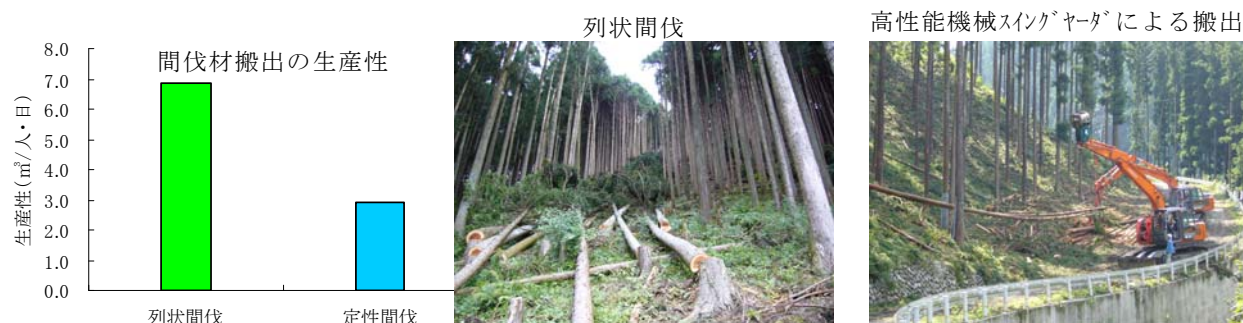
図8 列状間伐と高性能林業機械の組み合わせによる低コスト化
