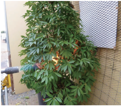
↑ ヤマグルマ(燃えにくい)の燃焼試験
