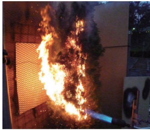
↑ ニオイヒバ(燃えやすい)の燃焼試験
