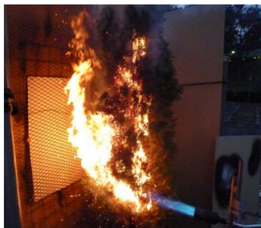
ニオイヒバ(燃えやすい)の燃焼試験
