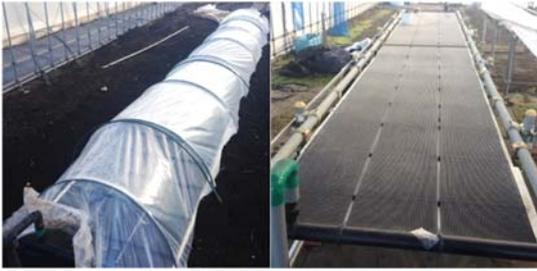
図1 熱交換器を利用した集熱装置
