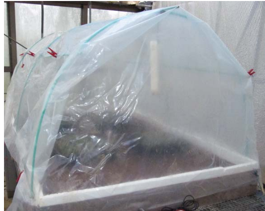
図1 密閉区の外観 (密閉にはクリンテートを利用)
