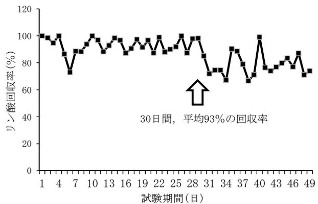
図2 発泡ガラスのリン酸吸着能力
