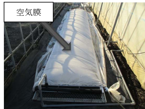
図3 集熱装置の外観 注) アグリマット1枚と空気膜構造
