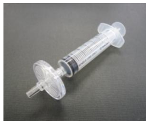
図1 シリンジにディスプレイダブルフィルターを装着した様子
