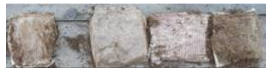
図4 底敷素材の違いと崩壊程度(2009)
