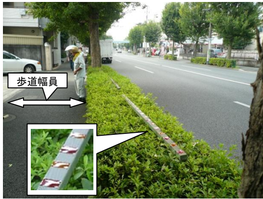
図1 日射計フィルムの設置
