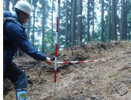
図5 勾配の大きい地点 (縦断勾配=24%)
