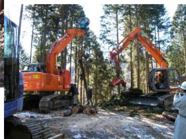
図8 スイングヤーダ(左)とプロセッサ(右)
