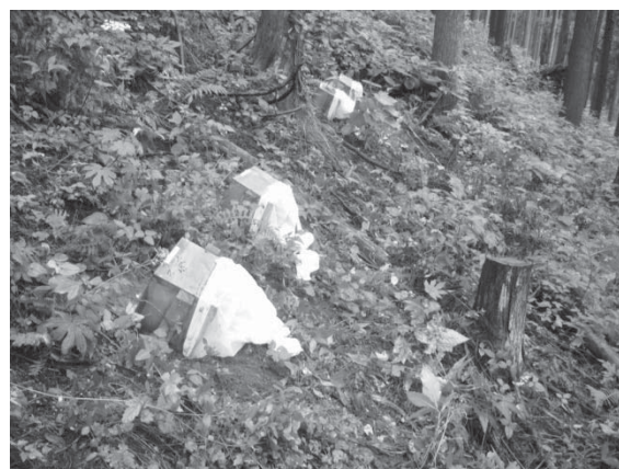
図1 土砂受け箱の設置状況(南郷)
