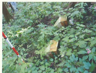
林内に設置した土砂受け箱です。3年間、定期的に流入した土砂を回収しました。
