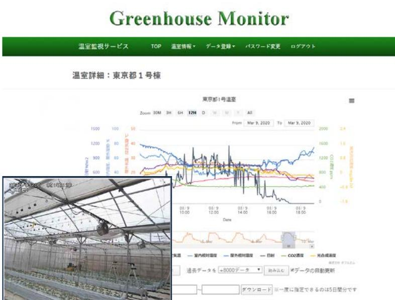
図1 遠隔監視制御システムとその出力画面
