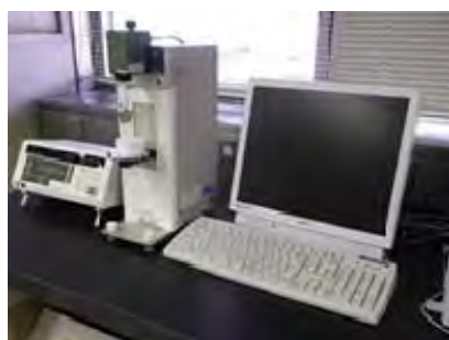
図3 物性試験機（クリープメータ）
