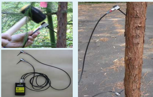
図 1 FAKOPPを使った材質調査の様子
