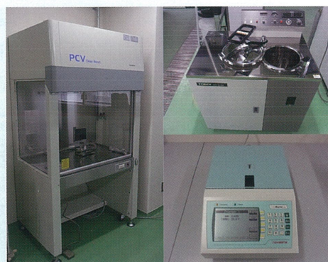
図4 増設した3機種 左：クリーンベンチ 右上：レトルト殺菌装置 右下：水分活性測定装置
