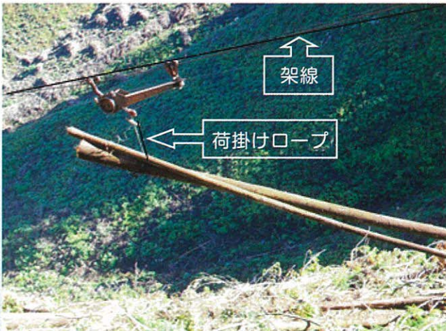
写真1 伐採した木を山から下ろす架線による集材作業
