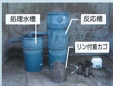
写真1 リン回収用装置
