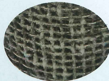
写真2 付着したリン成分（純毛様部分）
