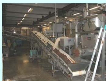
蒸煮大豆、米麴と食塩の混合工程
