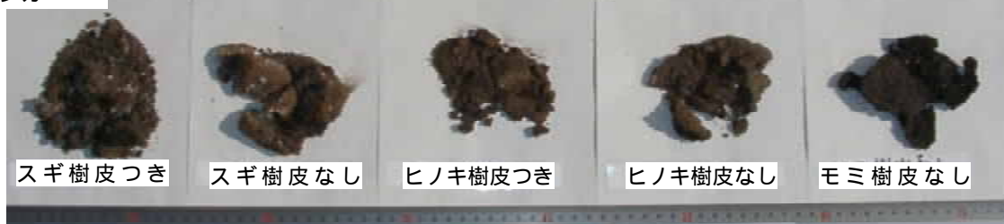
図 - 1 5種類のペレット及び燃焼皿にできたクリンカー
