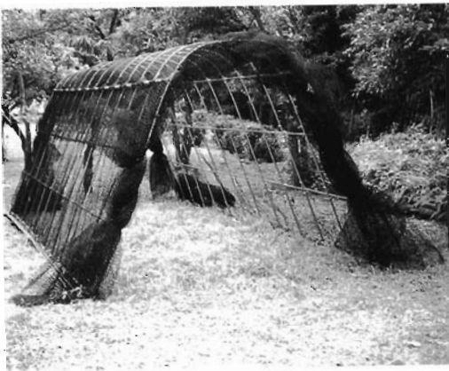
写真-3 組立式捕獲檻 (馴れ観察中) (高さ2m、間口2.4m、奥行き5.5m、 化学繊維ネット使用)
