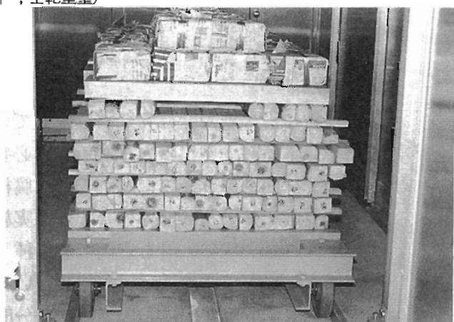
写真一、蒸気式乾燥機内の試験木 (最上部に250kgの重しがある)
