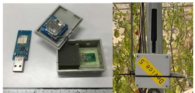
図4 試作無線化温度センサー（左）と長距離通信テストデバイス（右）
