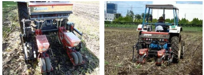
図1 不耕起播種機（左）と2作目の播種作業（右）
