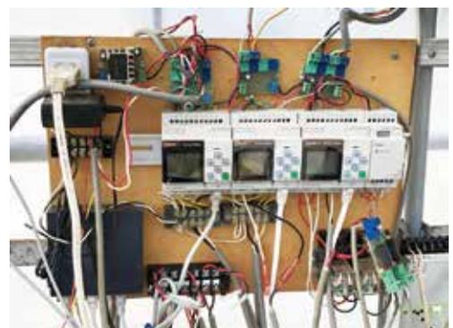
図2 給液管理システム制御部(開発中)
