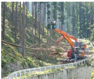
スイングヤーダによる搬出 写真1 列状間伐・搬出
