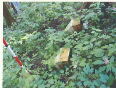
林内に設置した土砂受け箱です。3年間、定期的に流入した土砂を回収しました。
