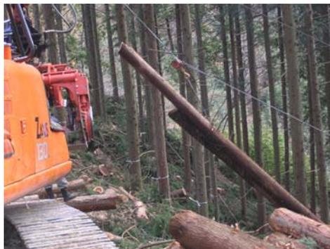
図17 スイングヤードによる搬出
