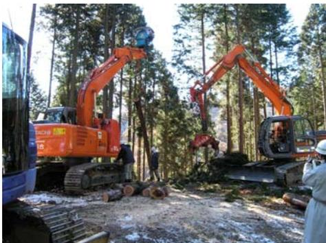
図16 スイングヤードとプロセッサの組み合わせ
