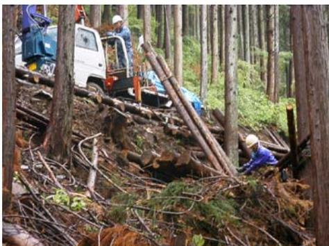
図22 簡易タワーヤードによる搬出
