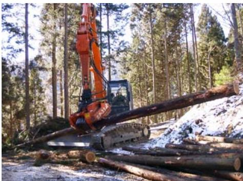
図18 プロセッサによる枝払・玉切
