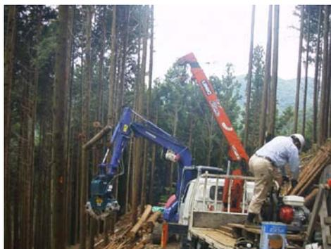
図21 簡易タワーヤードとグラップルの組み合わせ
