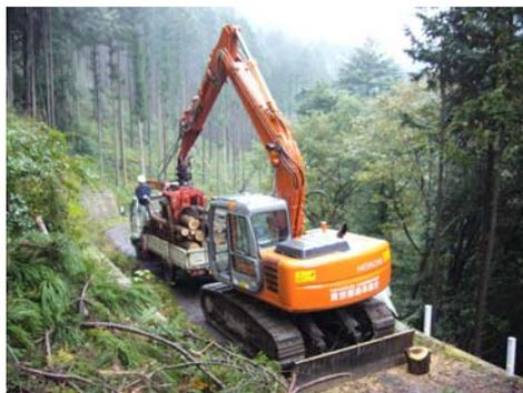
図19 プロセッサによる積み込み
